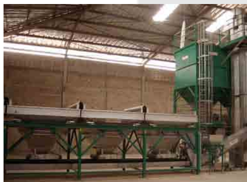
Weighcont à 3 trémies avec ensacheuse petits sacs
